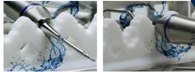
Speziell gestaltete Instrumentenauflagen ermöglichen eine nur punktuelle Auflage der Instrumente, wodurch auch unterhalb des Instruments eine Durchspülung möglich ist.
